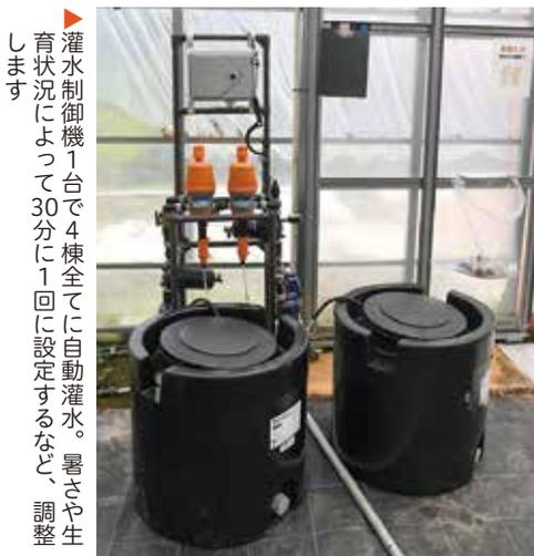
▶灌水制御機1台で4棟全てに自動灌水。暑さや生育状況によって30分に1回に設定するなど、調整します
